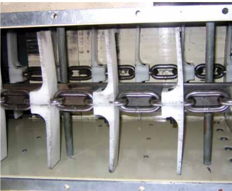
Penggunaan Rantai Mata Bulat Sistem Bolt-N-Go pada Konveyor
