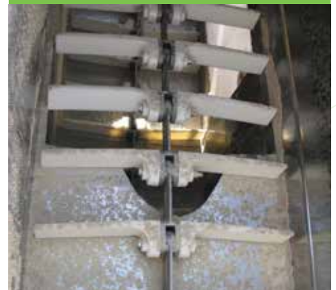
Penggunaan Rantai Bolt-N-Go dengan Pesawat Nilon pada Pabrik Pakan
