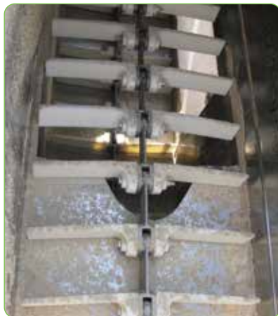
Penggunaan Rantai Bolt-N-Go dengan Pesawat Nilon pada Pabrik Pakan
