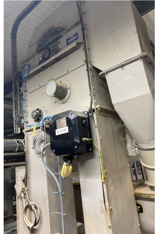
Cabeza de un elevador donde se muestra el nuevo sensor de alineación de la correa, el sensor de temperatura de los cojinetes y la caja de conexiones. Se puede apreciar la evidencia del roce entre el tambor y la correa causando marcas de quemaduras en la carcasa del elevador
