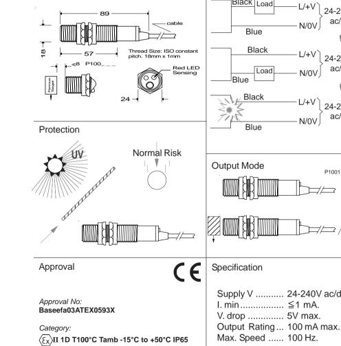
Connections Black L/+V 24-240V ac/dc N/0V Black L/+V 24-240V ac/dc Load N/0V L/+V 24-240V ac/dc N/0V P1001\_. P1002 -081(B) Supply V ..... 24-240V ac/dc. I. min ...... ≦1 mA. 544 V. drop ..... 5V max.
