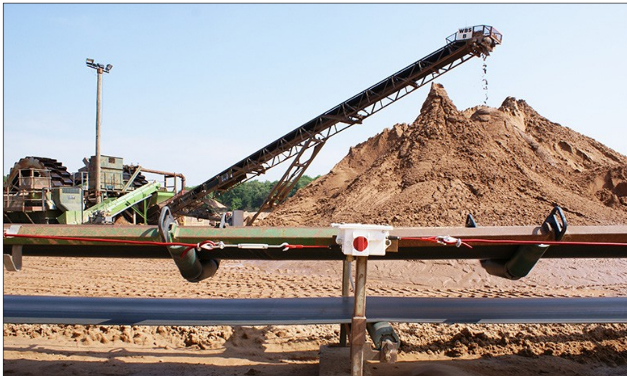
Pullswitch installé sur un convoyeur ouvert dans une installation de sable et de gravier
