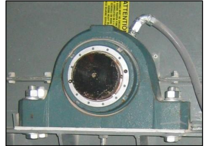
温度传感器安装在输送机轴承上
