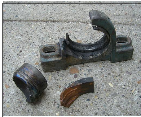
Exemple de défaillance du roulement
