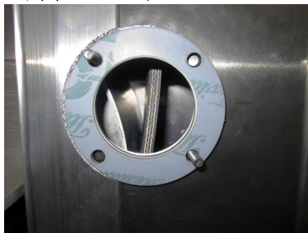
Рисунок 1 – Монтажное отверстие датчика TouchSwitch
