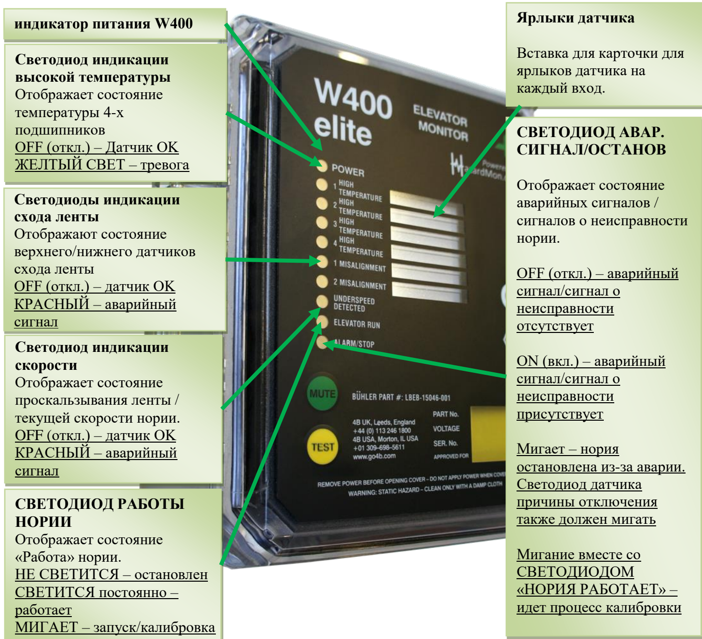
Рисунок 16 – Светодиоды контроллера W400
