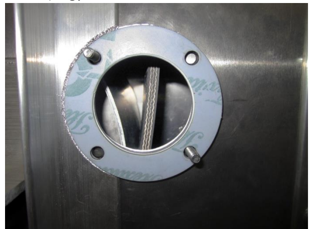
Figura 1 – A TouchSwitch érintőkapcsoló szerelőfurata
