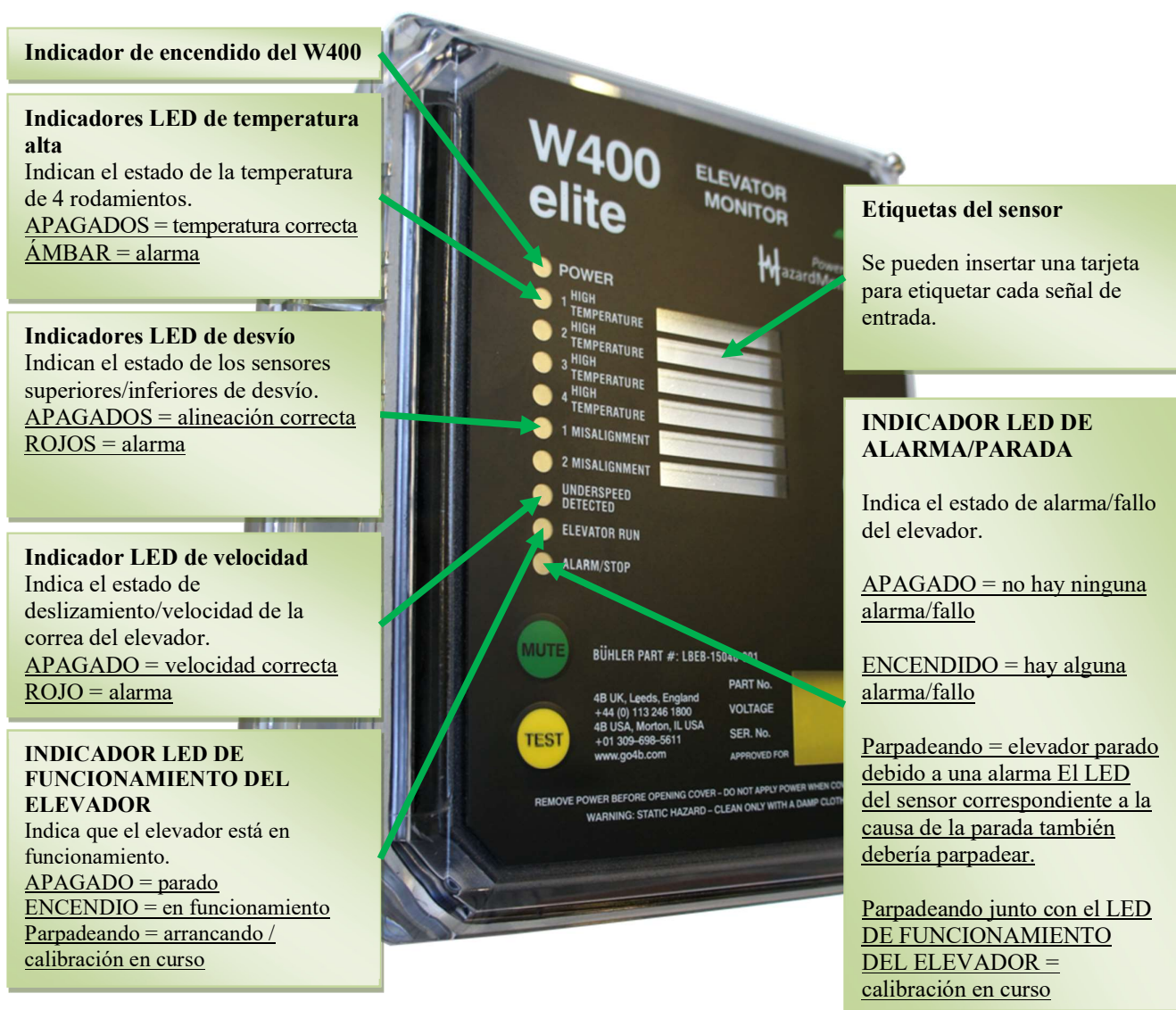
Imagen 16 – Indicadores LED del controlador W400
