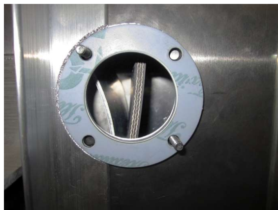
Imagen 1 – Agujero para el montaje del TouchSwitch™
