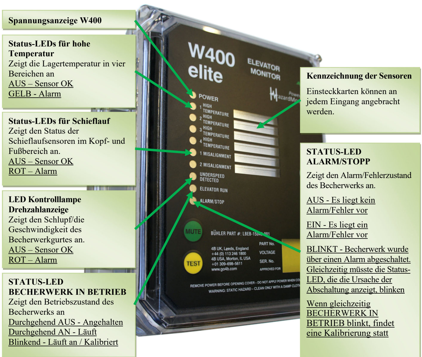
Abbildung 16 – Status-LEDs an der Kontrolleinheit W400
