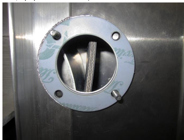
Рисунок 1 – Монтажное отверстие датчика TouchSwitch
