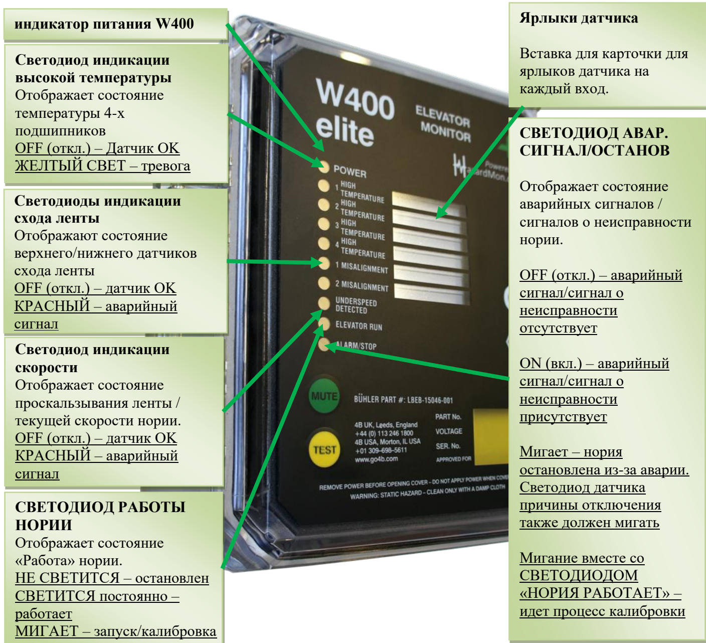
Рисунок 16 – Светодиоды контроллера W400
