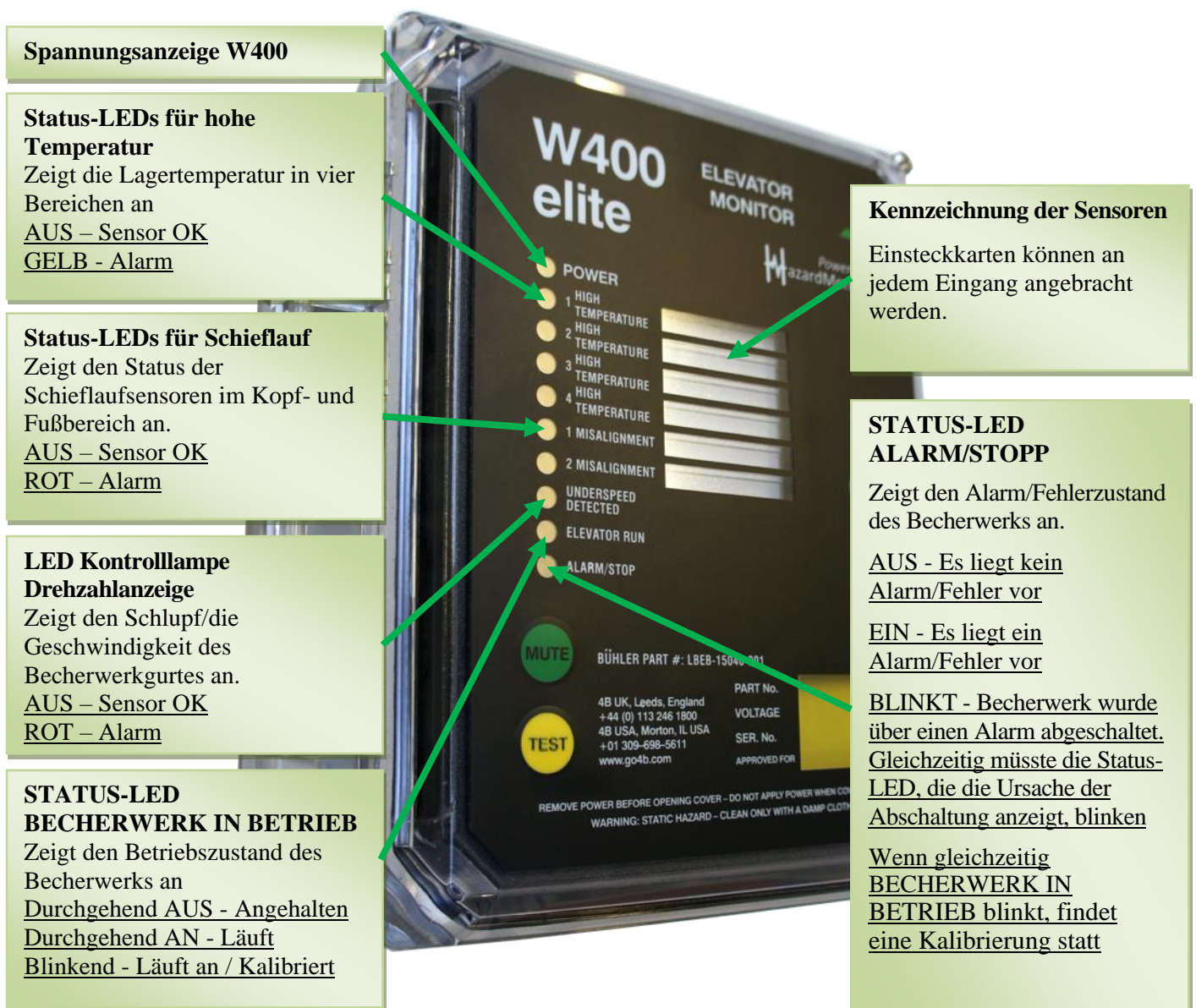
Abbildung 16 – Status-LEDs an der Kontrolleinheit W400
