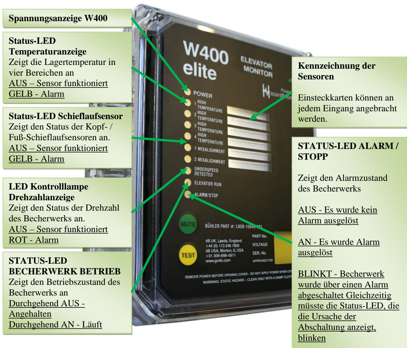
Abbildung 16 – Status-LEDs an der Kontrolleinheit W400
