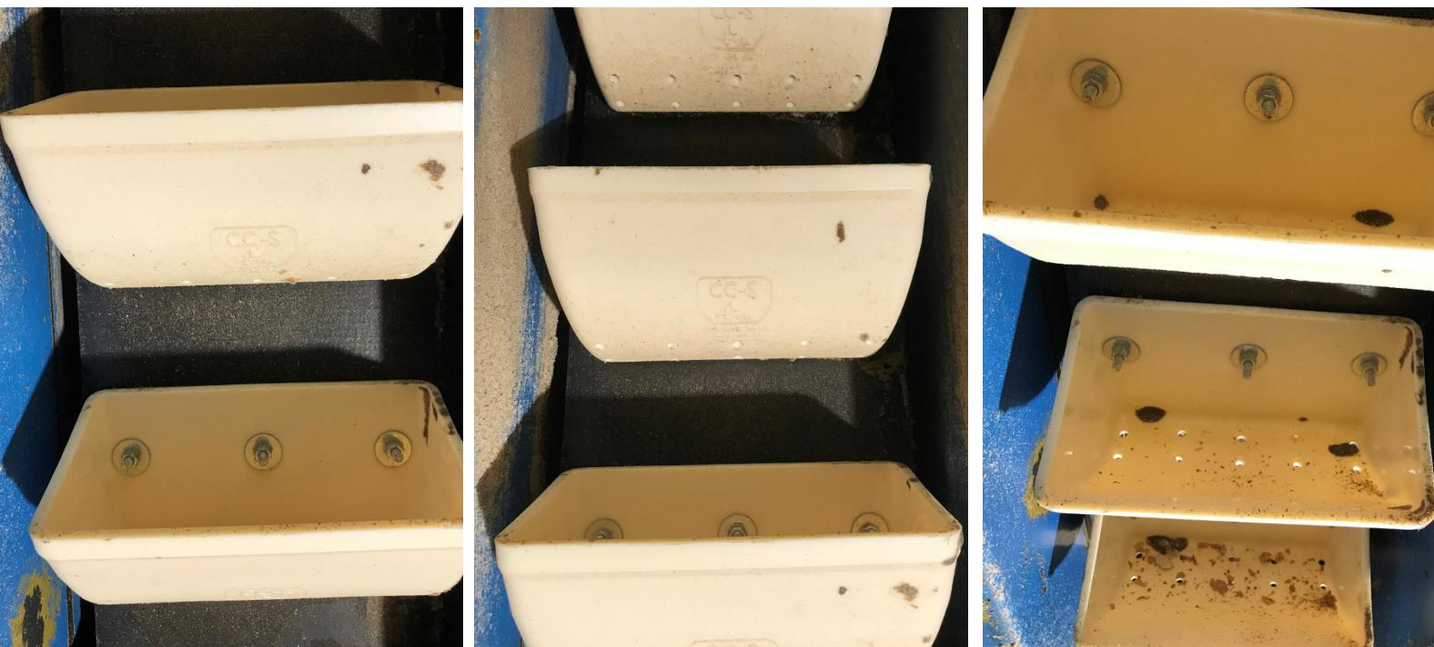
**Характеристики нории:** Нория с ПВХ лентой с шагом отверстий 200 мм для уретановых ковшей CC-S 9 X 5 с вентиляцией. Самоочищающийся башмачный барабан крыльчатого типа.
