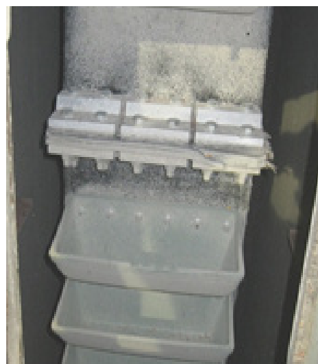
Installazione di tazze 16x8 a basso profilo JUMBO™ CC-S® 4B, giunzioni Braime 4B e nastro in gomma da 175 N/mm
