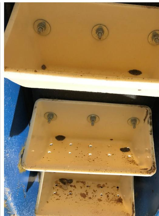
**Datos del elevador:** Elevador con correa PVC250 de 25 cm de ancho y separación de 20 cm para cangilones de uretano CC-S 9 x 5 con respiradero. Polea de la bota autolimpiable con alerones.
